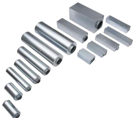
Die Schalldämpfer sind zum Einsatz in raumluftechnischen Anlagen bestimmt. Im Bereich der Luftverteilung werden sie zur Reduzierung der Ventilatorgeräusche eingesetzt. Um die Geräuschübertragung zwischen benachbarten Räumen durch die Luftleitungen zu unterbinden, werden sie als sogenannte Telefonieschalldämpfer in das Leitungssystem integriert.
