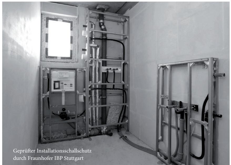
Geprüfter Installationsschallschutz durch Fraunhofer IBP Stuttgart
