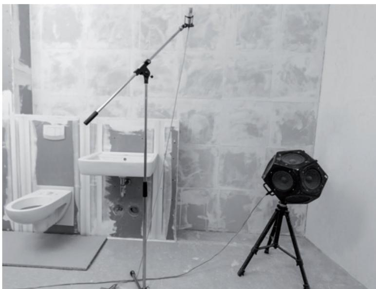
Im Rahmen von Prüfstands- und Gebäudemessungen konnte gezeigt werden, dass auch **entkoppelte Installationswände aus Gips-Wandbauplatten** deutlich günstigere schalltechnische Eigenschaften aufweisen, als aufgrund ihrer flächenbezogenen Masse zu erwarten wäre. Das zentrale Element dieses schalltechnischen Verhaltens ist auch hier die Entkopplung der Installationswände mittels Randanschlussstreifen.
