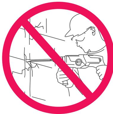
Alle Einschnitte werden vorzugsweise mit **MultiGips FG 70 Füll- und Zargengips** bei einer Überdeckung der Einbauteile von **mindestens 1 cm verschlossen.** Werden Schlitze und Ausnehmungen nicht verschlossen, ist die verbleibende Dicke der Wand für die Wandmaße nach DIN 4103-2 maßgebend.
