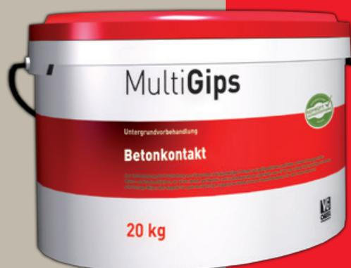
Betonkontakt ist eine mit mineralischen Zuschlägen gefüllte, gebrauchsfertig zu verarbeitende Haftbrücke auf Dispersionsbasis, die die Haftung von Gips-Trockenmörteln auf dichten, schwach saugenden Putzgründen verbessert, insbesondere auf Beton und Mauerwerk aus hochverdichteten Steinsorten.
