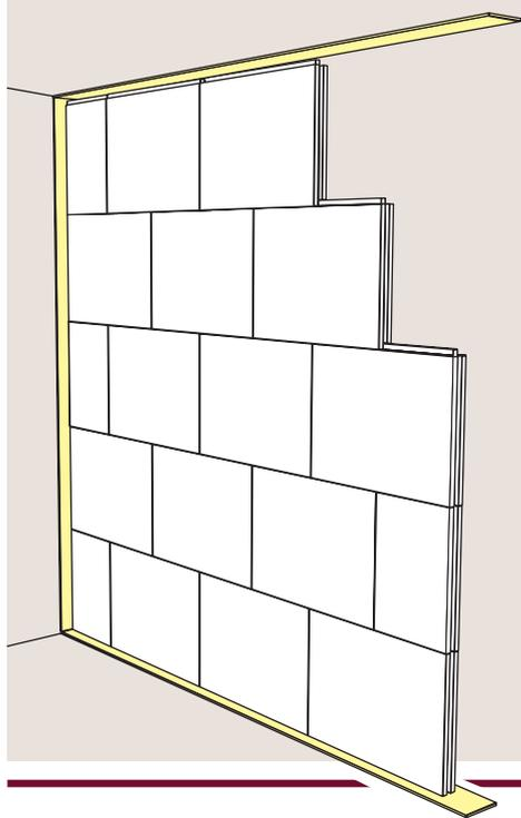
Bereits 80 mm schlanke Konstruktionen aus massiven Gips-Wandbauplatten wie **Innenwände**, **Versorgungs- und Lüftungsschächte** sowie **Bekleidungen von Stützen** bieten bis zu 120 Minuten Feuerwiderstand. Bei 100 mm dicken Platten sind es sogar drei Stunden, in denen Flammenüberschlag, Hitzedurchgang und Versagen der Wände ausgeschlossen werden können.
