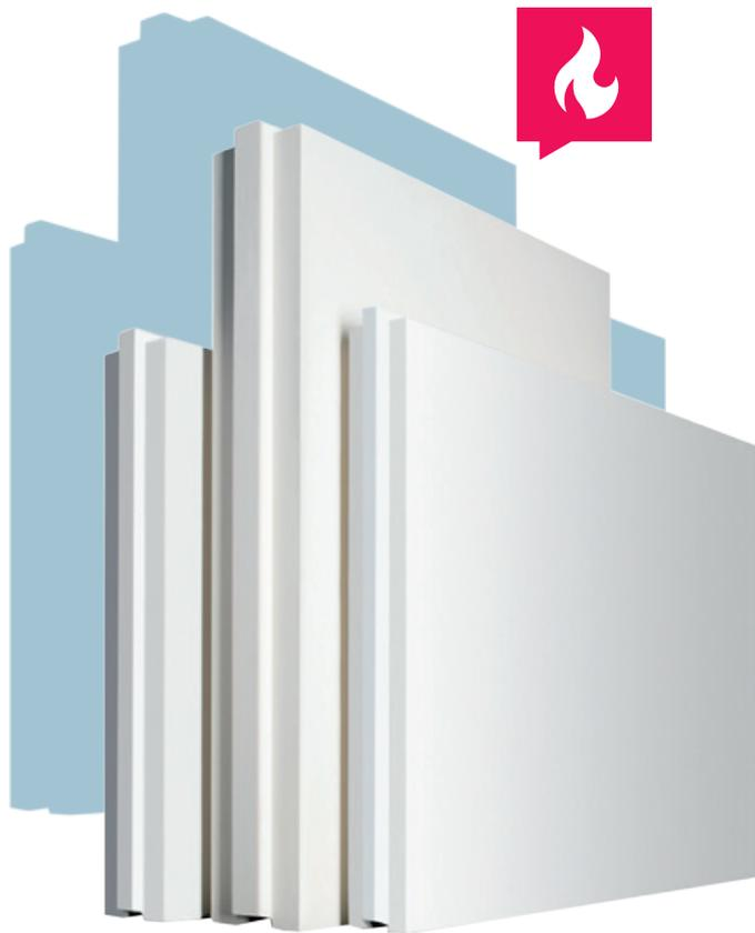
Bei hohen Temperaturen, wie sie im Brandfall auf das Bauteil einwirken, werden Konstruktionen aus Gips-Wandbauplatten „entwässert“. Aufgrund dieses Vorgangs werden große Wärmemengen auf der beflamten Bauteilseite nur sehr langsam und in nur sehr begrenztem Maße an die dem Feuer abgewandte Bauteilseite abgegeben – ein brandschutztechnischer Effekt, der Fluchtwege langanhaltend sicher macht und sich in idealer Weise zum Schutz der technischen Gebäudeausrüstung nutzen lässt.
