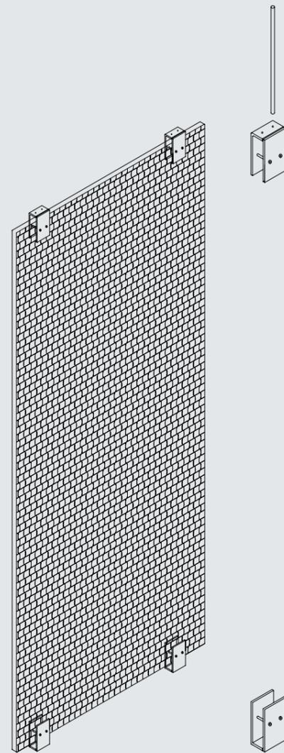
Die Trennwände sind an Decke und Boden mit pulverbeschichteten, alufarbenen Stahlverbindern befestigt. Bei Decken, die höher als 3.080 mm sind, kommt ein Verlängerungsrohr zum Einsatz. In der Standardausführung sind die Raumteiler transparent, farbige Oberflächen sind möglich.
