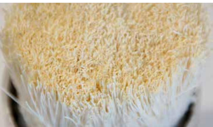
Die Membrantechnologie verwendet Bündel von Hohlfasermembranen, um Stickstoff aus der Umgebungsluft zu gewinnen.
