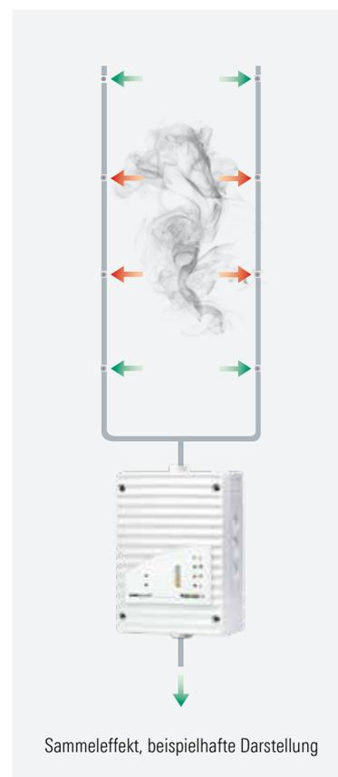
Der TITANUS®-Ansaugrauchmelder bietet eine aktive Luftprobenentnahme und erfüllt damit besonders hohe Anforderungen der Branddetektion.
