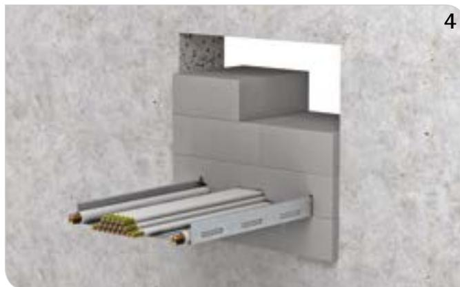
Brandschutzkitt um die Kabel in der Öffnung auf einer Länge von mindestens 10 cm auftragen und weitere Pacifyre® IWS Brandschutzsteine auflegen.
