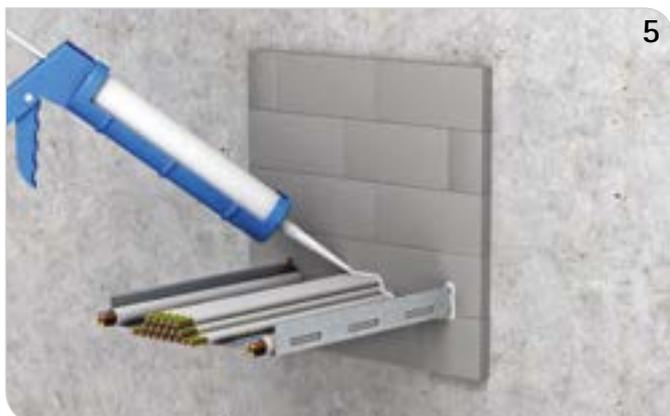
Nach dem Einbringen der Pacifyre® IWS Brandschutzsteine, Restspalte mit Brandschutzkitt verschließen.
