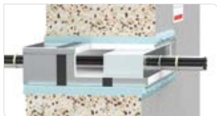
Zwei Schaumstoffplatten doppelt am zugängigen Boxenende (einseitig) montierbar.
