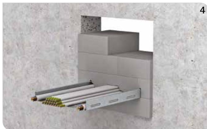
Die Pacifyre® Brandschutzsteine fugenversetzt so einbauen, dass ein dichter Anschluß an das Bauteil entsteht.
