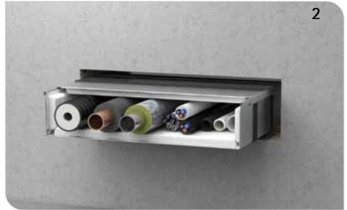
Pacifyre® CB Kombibox um die Leitungen legen und verschiebbaren Deckel schließen. Kombibox mittig im Bauteil montieren.
