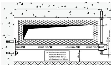
Konsolenkonstruktion mit Kabeltrasse
