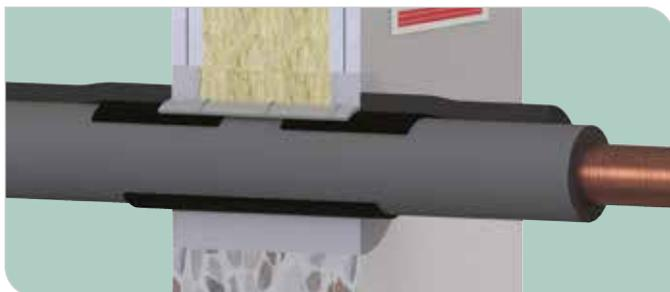
Bei Leichtbauwänden mit einer Bauteilstärke von  $\geq 100$  mm müssen Zusätzmaßnahmen für die Auslaibung (z.B. Einbau von Blechhülsen) getroffen werden. Bei Rohren mit einem Außen- $\varnothing \geq 88,9$  mm wird zudem eine Schutzisolierung benötigt.
