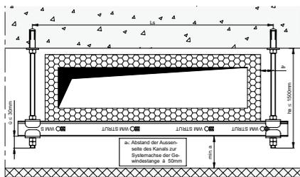
Profilschienen abgehängt mit Kabeltrasse
