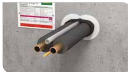
Anschlussleitungen für Kältegeräte (Splitgeräte) mit Kondensatleitung und einem Kabel
