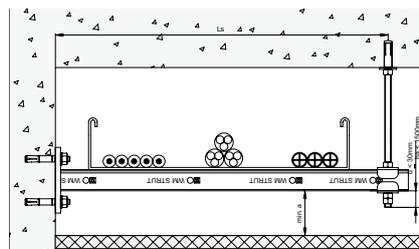
Profilschienen abgehängt mit abgehängten Rohrschellen
