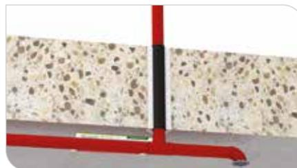
Nicht brennbare (bis Außen-Ø 160 mm) oder brennbare (bis Außen-Ø 32 mm) Sprinklerleitung
