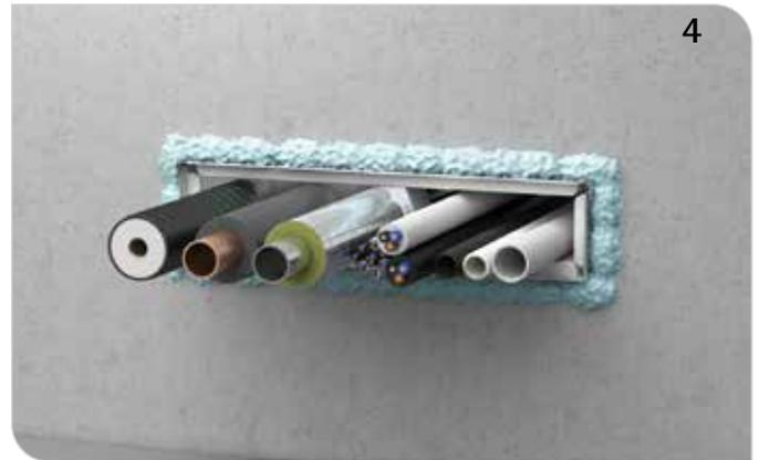
Mitgelieferte Schaumstoffplatten zuschneiden und beidseitig am Boxenende einbauen. Statt der Schaumstoffplatten kann Soudafoam Gun B1 verwendet werden.
