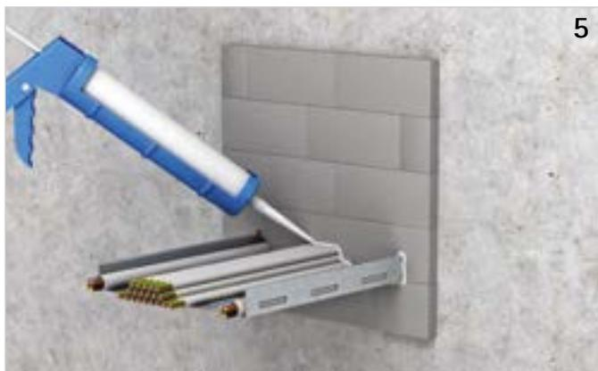
Nach dem Einbringen der Pacifyre® IWS Brandschutzsteine, Restspalte mit Brandschutzschaum verschließen.
