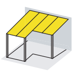
Pultdach mit Dachrinnenversatz
