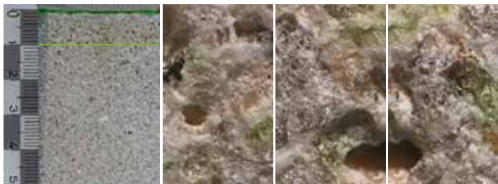
Penetrationstiefe Wecryl 130 bei 8 °C Untergrundtemperatur
