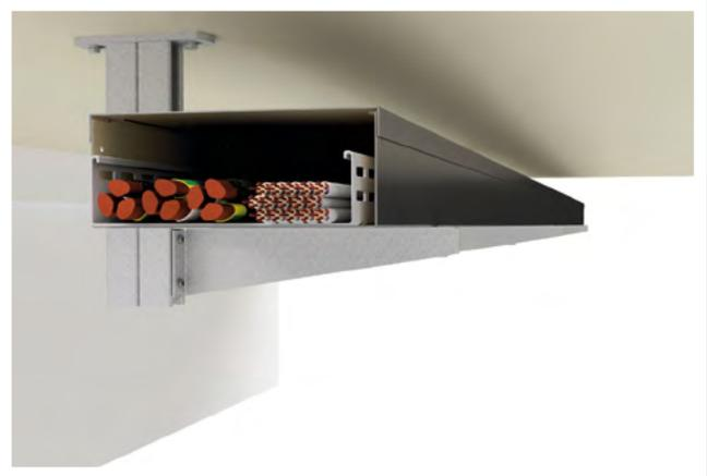
Abgehängte Montage mit sehr großer „Spannweite“ von bis zu 2100 mm. Die Kabel dürfen mit oder ohne Kabelrinne verlegt werden. Ebenfalls ist eine Variante mit seitlich verschraubtem Deckel möglich.
