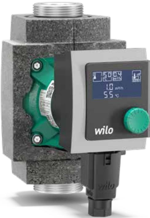
Dank einfacher Installation und Inbetriebnahme ist das Trinkwarmwasser-Zirkulationssystem im Haus schnell und sicher geschützt vor Legionellen. Die Premium-Hocheffizienzpumpe Wilo-Stratos PICO-Z unterstützt automatisch die thermische Desinfektion des Trinkwarmwasserspeichers. Ab einer eingestellten Temperatur von 55 °C wird die Gefahr der Keimbildung im Zirkulationssystem vermindert.
