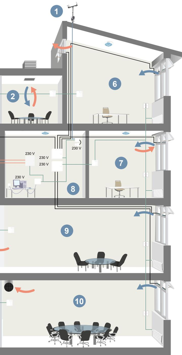
6. Bei Fenstern auf beiden Seiten des Raums wird die Querlüftung verwendet. Fühler an der Wand messen Temperatur, CO<sub>2</sub>-Niveau und Luftfeuchtigkeit, während den Benutzern die Möglichkeit geboten wird, per Druckschalter Fenster und Sonnenabschirmung manuell zu steuern. In der Decke befindet sich ein PIR-Melder, der Bewegungen erfasst und das Licht je nach Nutzung des Raumes ein- bzw. ausschaltet.
