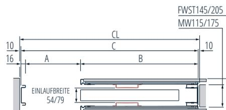
FWST = Fertigwandstärke | MW = Mauerwerk
