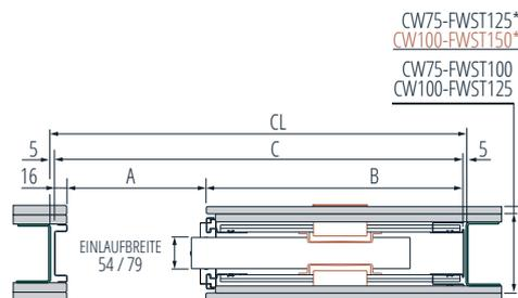
FWST = Fertigwandstärke | CW = Profilstärke | \* Doppelbeplankung
