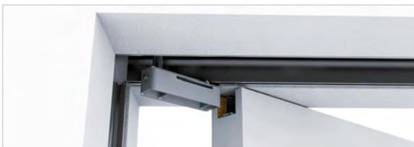
Zuerst den hinteren Beschlag am Laufwagen befestigen. Beschlag bündig in das Türblatt einführen. Das Türblatt in den Einlauf eindrehen und bis zum hinteren Fangstopper einfahren.
