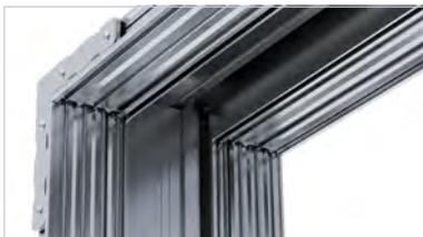
**Laibungsprofil** Die Beplankung wird bei der Montage bis an das Profil herangeführt. Die Profilkontur bildet beim Verspachteln eine kraftvolle Verbindung zwischen Gipskarton und Laibungsprofil und dient als Kantenschutz.
