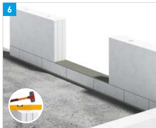
Ecksteine setzen und ausrichten
