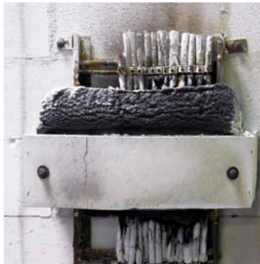
Abb. 3: ZZ W20 nach der 90-minütigen Brandbeanspruchung nach Einheitstemperaturkurve (ETK)
