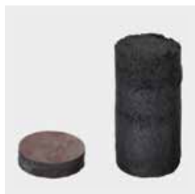
Intumeszenzwirkung Baustoff ZZ-Brand-schutzschaum BDS-N maximal
