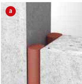
a. Trenn- und Dehnfugen von großflächigen Massivbauteilen
