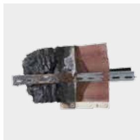
2. Brandprüfung: System ZZ-Steine 200 BDS nach Brand
