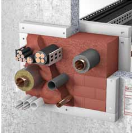
Kombiabschottung ZZ M30-S90 in Massivwand
