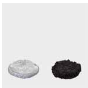
Intumeszenzwirkung Baustoff ZZ-Brand-schutzsilikon NE
