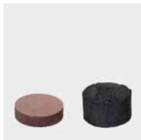
1. Entwicklung Intumeszenz: Intumeszenzwirkung Baustoff ZZ-Brandenschutzschaum BDS-N minimal
