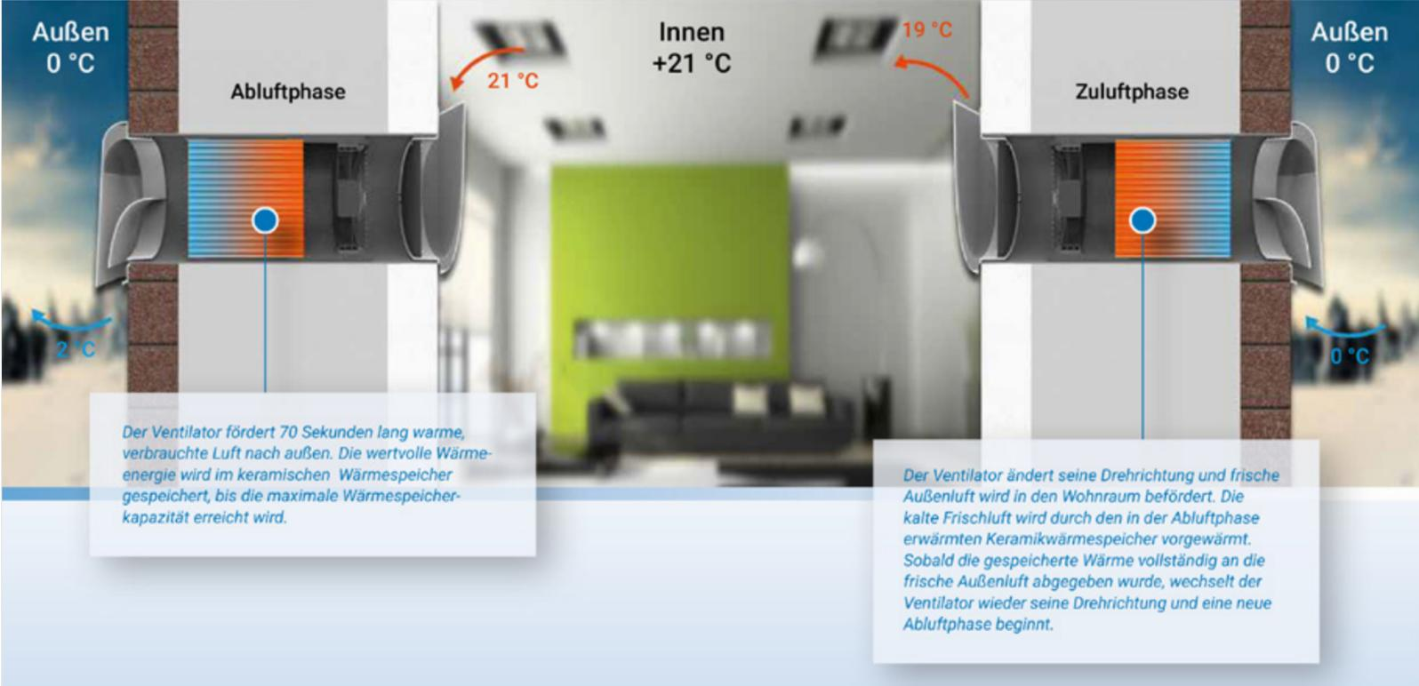
Der Ventilator fördert 70 Sekunden lang warme, verbrauchte Luft nach außen. Die wertvolle Wärmeenergie wird im keramischen Wärmespeicher gespeichert, bis die maximale Wärmespeicherkapazität erreicht wird.
