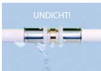
Bei üblichem Anlagendruck geprüfter, unverpresster Fitting (unverpresst-undicht)
