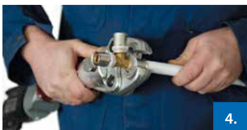
Abbildung 4: Verpressung / Beenden des Pressvorgangs
