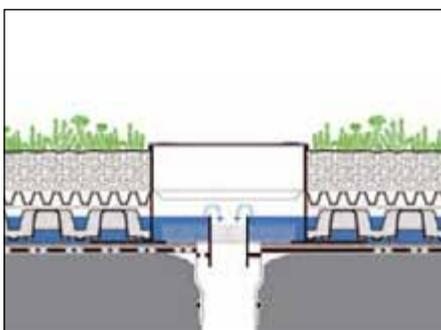
Bei extremen Niederschlagsereignissen staut sich das Wasser im Retentionsvolumen bis zur Oberkante des Staurohres an.
