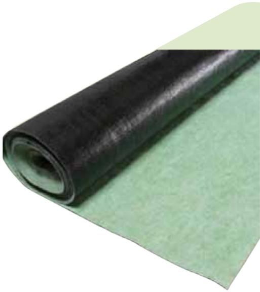
Das neue, gebrauchsmustergeschützte Aquafleece AF 300 ist das Kernstück der neuen Systemaufbauten „Klima-Gründach und „Bewässerte Extensivbegrünung“. Durch die Kombination eines hoch-kapillaren Vlieses mit einem Bändchengewebe kann das Aquafleece das Wasser im Bewässerungsfall verteilen, während es bei Niederschlägen das überschüssige Wasser flächig nach unten passieren läßt. So ist eine gleichmäßig Bewässerung möglich, eine Vernässung des Substrates aber wirkungsvoll unterbunden.
