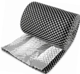
Für eine besonders rationelle Verlegung von Begrünungsaufbauten mit Floradrain® FD 40 gibt es dieses auch als Rollenware mit aufkaschiertem Systemfiltervlies. Das Systemfiltervlies hat einen einseitigen Überstand von ca. 100 mm. Das größere Transportvolumen von Rollenware gegenüber Plattenware ist jedoch zu beachten! Material: aus tiefgezogenem Recycling-Polyolefin (hpts. PE).
