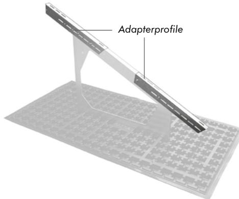
Aus einem Stück gefertigtes Adapterprofil, welches die Aufnahme besonders großer Module auf dem ZinCo Solar-Grundrahmen SGR ermöglicht. Befestigung mit mind. zwei Schrauben je Profil. Die Auflagefläche der Adapterprofile auf dem Grundrahmen muss mindestens 25 cm betragen, somit krägt das Adapterprofil max. 45 cm über diesen hinaus. Pro Solargrundrahmen können zwei Adapterprofile (oben und unten) eingesetzt werden. Die Lieferung erfolgt inkl. zwei Schrauben M6 und zwei Zahnmuttern M6.
