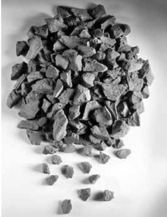
Zincolit® ist ein hochwertiges Recycling-Produkt auf der Basis von speziell aufbereiteten Tonziegeln; strukturstabil, frostbeständig und nicht brennbar. Es entspricht den Anforderungen der Düngemittelverordnung. Zincolit® Plus besteht aus Zincolit® und ausgewählten Zuschlagstoffen. Es eignet sich besonders
