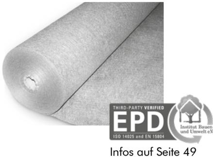
Filtervlies aus vorkomprimiertem und thermisch verfestigtem Polypropylen; verrottungsbeständig; einsetzbar als Filterschicht auf den ZinCo Dränelementen bei **normaler mechanischer Beanspruchung**; Wasserdurchlässigkeit  $H_{50}$  nach EN ISO 11058: ca. 70 l/(m<sup>2</sup> × s); Öffnungsweite ( $O_{90}$ ) nach EN ISO 12956: ca. 95 µm; Geotextilrobustheitsklasse 2; Flächenmasse: ca. 100 g/m<sup>2</sup>.
