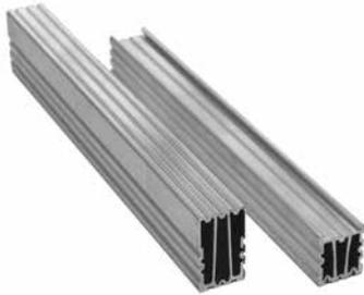
Basis des Elefeet® Schienensystems sind stranggepresste leichte Aluminium-Profile, Material EN AW 6060 T66, mit entsprechenden Verbindern aus verzinktem Stahl, die in Kombination mit Elefeet® Stelzlagern das zügige Herstellen einer stabilen Terrassen-Unterkonstruktion ermöglichen. Speziell geeignet auch bei nicht allseitig eingefassten Gehbelägen aus Beton- oder Natursteinplatten sowie Holz- oder WPC-Dielen.
