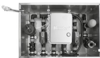
Fertig vormontierte Kopfstation zum Außeneinsatz für automatisierte Bewässerung speziell von Dachbegrünungen: verriegelbare Edelstahlbox inkl. Kupplung für Wasserzuleitung 32 mm; Filter; Druckminderer; Anschluss für Gartenschlauch; Bewässerungszeitsteuerung durch Batterie (daher kein Stromanschluss erforderlich); 4 Magnetventile 1" inkl. Kupplungen für 32 mm Verlegerohr sowie Regensensor. Gewicht: ca. 14 kg; benötigter Wasserdruck (Fließdruck!): min. 1,5 bar.
