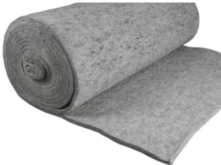
Unverrottbare, thermofixierte Nadelvliesmatte aus Mischfasern; verwendbar als Wasserspeichermatte unter Dachbegrünungen, speziell für geneigte Dächer; bitumenverträglich; biologisch und chemisch neutral; reißfest; hergestellt aus Recycling-Synthefasern. **Wasserspeicherkapazität: ca. 12 l/m<sup>2</sup>**; Dicke: ca. 17 mm; Flächenmasse: ca. 1500 g/m<sup>2</sup>.
