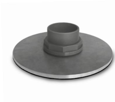
Anstaeuelement zum Aufsetzen auf Flachdachabläufe mit Anschlusskragen und Mindestgröße DN 100. Gewicht ca. 4,6 kg. Besteht aus einem Edelstahlflansch mit unterseitiger Gummidichtung, Durchmesser ca. 280 mm und einem höhenverstellbarem Überlaufstutzen (Einstellbereich von ca. 10–75 mm) aus Kunststoff, Innendurchmesser ca. 75 mm.
