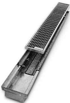
Wie auf Seite 30, jedoch längenverstellbar durch teleskopartig verschiebbaren Rinnenkörper. Der Gitterrost ist entsprechend abzulängen und an der Schnittstelle gegen Korrosion zu schützen. Erhältlich in den Maßen 0,60 m–1,00 m und 1,15 m–2,00 m; Höhe ca. 50 mm; Gewicht: ca. 5,4 kg bzw. 10,0 kg.
