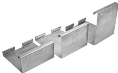
Die ideale Art, die DP-Profile zu fixieren, ohne in die Dachabdichtung einzugreifen. Der DP-Fix-Halter aus Aluminium wird mit einer ca. 750 mm × 500 mm großen, vorgeschlitzten Fixiermatte geliefert. Als Stoßverbinder sorgt er für ein homogenes Erscheinungsbild. Es kann bis zu einer Dachneigung von 5° als Abschlussprofil, zur Einfassung von Begrünungen, als Kiesfangleiste oder als Übergangsprofil (Kies/Begrünung/Plattenbelag) eingesetzt werden. Auf Anfrage auch in Edelstahl erhältlich.
