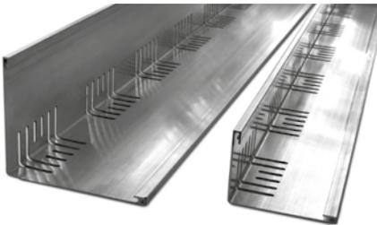
Beidseitig verwendbare Winkelprofile aus stranggepresstem Aluminium natur mit Entwässerungsschlitzen über Eck; zur Trennung unterschiedlicher Aufbauten, wie z. B. Kiesrandstreifen zu Begrünungen, Randstreifen aus Zincolit® oder ähnlichem.
