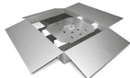
Durch Auflast gehaltene, dachdurchdringungsfreie Anschlagseinrichtung gegen Absturz gemäß DIN EN 795:2012 Typ E, bestehend aus zu einer Scheibe zusammengesteckten und mit Substrat oder Kies überschütteten Rasterelementen und einem im Innenbereich der Scheibe platzierten Anschlagpunkt mit Ringöse.
