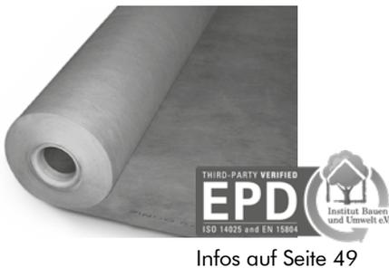
Thermisch verfestigtes Filtervlies aus Polypropylen; **mechanisch hoch belastbar**, daher einsetzbar auf Dränschüttungen; Wasserdurchlässigkeit  $H_{50}$  nach EN ISO 11058: ca. 40 l/(m<sup>2</sup> × s); Öffnungsweite ( $O_{90}$ ) nach EN ISO 12956: ca. 85 µm, Geotextilrobustheitsklasse 3; Flächenmasse: ≥ 175 g/m<sup>2</sup>.
