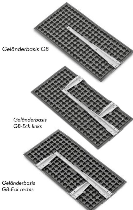
Aus profiliertem ABS-Kunststoff mit unterseitigen Aussteifungsprofilen aus Aluminium, Pfostenaufnahme(n) mit Schraubflansch aus feuerverzinktem Stahl. Universell für Pfosten mit passendem Schraubflansch (Lochabstand 100 mm × 75 mm). Geprüft nach DIN 1055 Teil 3 für Horizontalkräfte bis 1 kN/m, bestehend aus:
