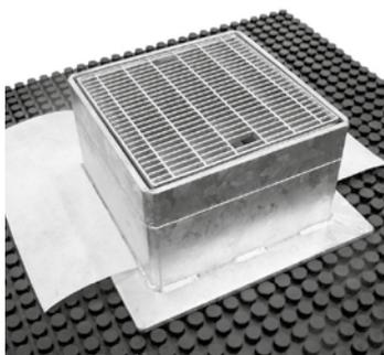
**Befahrbarer Entwässerungsschacht aus feuerverzinktem Stahl**; Schacht-Außenmaß ca. 300 mm × 300 mm; Flansch: ca. 400 mm × 400 mm; mit verschraubtem Gitterrost; Maschenweite: ca. 11 × 41 mm; Sandfang aus Aluminium und druckverteilendem Auflageflansch; Öffnungsmaß: ca. 200 mm × 200 mm.
