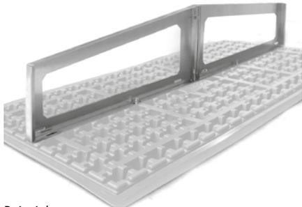
Schraubenset zum Herstellen einer Ost-West ausgerichteten Solaraufständerung, um die SB 200-4 und zwei SGR zu montieren. Pro Aufständerung werden zwei SGR (siehe Seite 44), Art.-Nr. 9700xx und eine SB 200-4 Art.-Nr. 3465 benötigt. Die Montage kann mit einem Hochpunkt zwischen den beiden Modulreihen erfolgen („Sattel“) oder mit einem Tiefpunkt („Schmetterling“). Material: Edelstahl.
