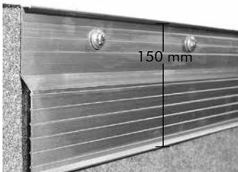
Anpress- und Schutzprofil gegen UV-Strahlung und Witterungseinflüsse; für Folien- und Bitumenabdichtungen; aus Aluminium-natur; stranggepresst; mit breiter Auflagefläche; entsprechend den Flachdachrichtlinien; vorgelocht im Abstand von ca. 200 mm; Profil-Höhe: ca. 150 mm.
