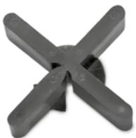
Fugenkreuz, Schenkelstärke 5 mm; Schenkelhöhe 11 mm; aus unverrottbarem Kunststoff; zur problemlosen, zeitsparenden und dauerhaft präzisen Verlegung von Plattenbelägen auf einer Ausgleichsschicht; werkzeuglos abtrennbarer vierter Schenkel für Läuferverlegung.
