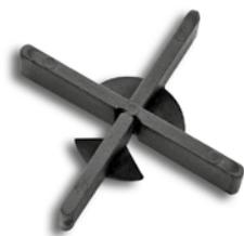
Mit dem 3 mm dicken Fugenkreuz kann ein einheitliches Fugenbild auch dort sichergestellt werden, wo kein Elefeet® Stelzlager direkt unter dem Platten-Kreuzungspunkt platziert werden kann (z. B. im Bereich von Gehrungs- und Randauflagern); werkzeuglos abtrennbarer vierter Schenkel für Läuferverlegung.
