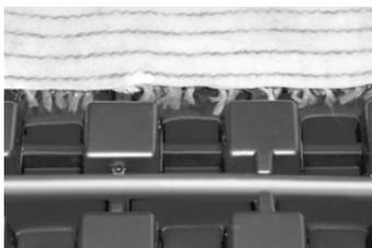
Tropfschlauch für die Bewässerung von Dachbegrünungen in Verbindung mit dem Wasserverteil-, Speicher- und Dränelement Aquatec® AT 45 und dem Dochtvlies DV 40. Durchmesser ca. 16 mm, mit im Schlauch angeordneten Tropfern, Tropferabstand: ca. 100 mm; Tropferleistung: ca. 1 l/h; druckkompensierend.
