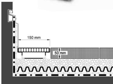
Stabile, an den Stößen verschraubbare Rinne aus Stahlblech, verzinkt und kunststoffbeschichtet, mit begehbarem, feuerverzinktem Gitterrost; sichert den zügigen Abfluss des an Fassaden verstärkt anfallenden Niederschlagswassers; ermöglicht niedrige Anschlusskonstruktionen im Tür- und Terrassenbereich (Sonderlösung nach DIN und Flachdachrichtlinien). Endstücke können bei Bedarf von Hand nach innen geklappt werden (nur bei FR 75); Rost-Maschenweite: ca. 33 mm × 11 mm; Breite: ca. 150 mm.
