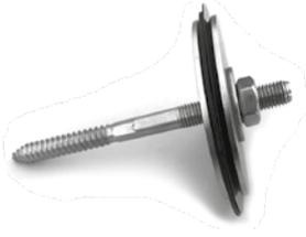
Zweiteiliger Schraubanker aus Edelstahl zur Aufnahme von Zug- und Schubkräften bis 1,5 kN bei abgedichteten Dächern, bestehend aus Stockschraube, Länge ca. 150 mm, Ø10 mm, mit angeschweißter Grundplatte (Festflansch) und loser Anpressplatte (Losflansch), Ø jeweils 70 mm, Dicke jeweils 4 mm, einschl. Zubehör zur Befestigung in Holzuntergrund. Bei Schubfix LF 150 handelt es sich um ein System „Los-Festflansch“ in Anlehnung an die Flachdachrichtlinie.
