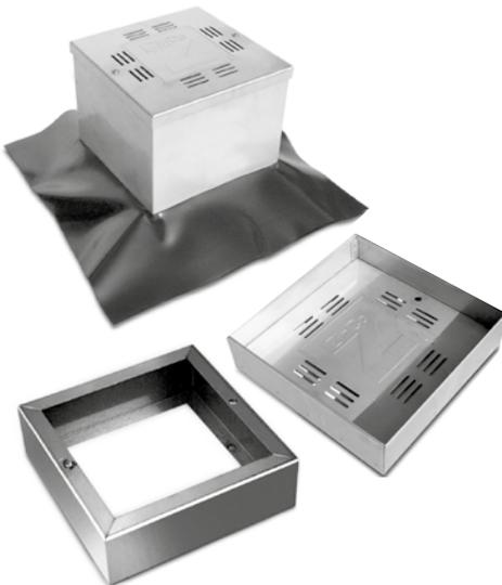
Hochwertiger Kontrollschacht aus **Edelstahl (V2A)** mit ringsumlaufender Schlitzlochung zur Aufnahme von Dränwasser; verschließbarer, trittstabiler Deckel mit Wassereinlassöffnungen und mit in der Höhe verschiebbarer Folien-Manschette zum lückenlosen Anschluss des Systemfiltervlieses. Farbe: Edelstahl natur; Gewicht: ca. 4,0 kg; Schacht-Außenmaß: ca. 300 mm × 300 mm; Öffnungsmaß: ca. 240 mm × 240 mm.
