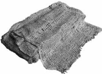
Schweres, grobmaschiges Gewebe aus 100 % Jute, welches die Wind- und Wassererosion auf frisch humusierten Flächen verhindert; Jute ist 100 % biologisch abbaubar; einsetzbar auf begrüntem Schrägdächern, an Böschungen, Hängen und Ufern, etc. Aus Umweltgründen ist das Jutegewebe **nicht flammhemmend** ausgerüstet, deshalb vor offenem Feuer oder Glut schützen. Flächenmasse: ca. 500 g/m<sup>2</sup>; Maschenweite: ca. 30–40 mm.
