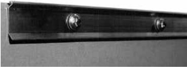
Schlankes Anpressprofil z. B. zur Fixierung von Wurzelschutzbahnen bzw. -folien oder von Teichbahnen an Betonrögen, Winkelsteinen etc.; aus Aluminium-natur; strang-gepresst; vorgelocht im Abstand von ca. 200 mm; Profilhöhe: ca. 40 mm.
