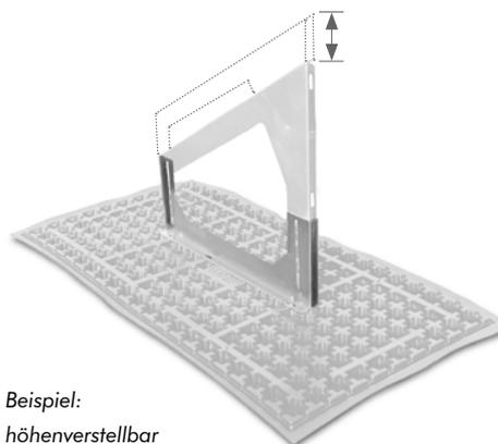
Unterteil aus Aluminium zur stufenlosen Höhenverstellung des Solar-Grundrahmens von bis zu 21 cm. Der Neigungswinkel von 5° bis 45° lässt sich um bis zu  $\pm 2^\circ$  verändern. Diese Eigenschaften garantieren eine optimale Anpassung an wechselndes Dachgefälle sowie eine bestmögliche Ausrichtung der Module. Gewicht: ca. 1 kg/Stück.
