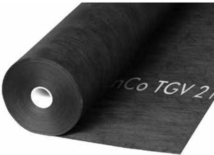
**Luft- und dampfdurchlässiges, jedoch wasserabweisendes**, thermisch gebundenes Vlies aus 100 % Polypropylen; einsetzbar als Trennlage bzw. Rieselschutz, z. B. bei begrüntem Umkehrdächern, zum Schutz von Metallen gegen schädigende Einwirkungen angrenzender Stoffe, etc.; chemisch und biologisch neutral; bitumen- und polystyrolverträglich; beständig gegenüber Säuren und Alkalien; diffusionsoffen ( $sd \leq 0,01$  m); Farbe: schwarz; Dicke: ca. 0,55 mm; Flächenmasse: ca. 80 g/m<sup>2</sup>.
