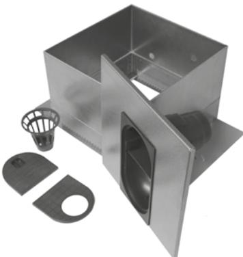
Kontrollschacht aus Aluminium und verzinktem Stahl, pulverbeschichtet, mit ausziehbarem Flansch. Farbe: altsilber-antik. Eingebauter Regensinkkasten zum Anschluss verschiedener Rohrdurchmesser (DN 80, 90, 100, 110, 120, 125); inkl. Rückstauklappe, Laubfangkorb und Revisionsöffnung. Gewicht: ca. 7 kg; Höhe: ca. 300 mm; Schacht-Außenmaß: ca. 400 × 400 mm; Zubehör: Aufstocker KSA 10/40
