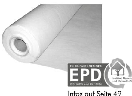
Hitzebeständiges Vlies aus verfestigtem Polyester zum Einsatz auf Elastodrain® EL 202 für den Handeinbau von Asphaltbelägen. Bitte Einbauanleitung beachten! Dicke ca. 1,0–1,4 mm, Flächenmasse ca. 200 g/m<sup>2</sup>, Farbe weiß, Höchstzugkraft min. 400 N/5cm, Reißdehnung längs/quer ca. 35/50 %, Schmelzpunkt > 200 °C.
