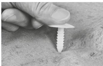
Aus Polyethylen; zur punktuellen Befestigung von Filtervliesen auf allen Dränelementen aus EPS-Hartschaum (Floraset®). Bedarf: ca. 1 Vliesknopf/m<sup>2</sup>. Kopfdurchmesser: ca. 30 mm; Stiftdurchmesser: ca. 8 mm; Stifflänge: ca. 34 mm.
