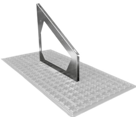
Statisch geprüfter, aus einem Stück gefertigter Rahmenträger aus Aluminium; abgestimmt auf die ZinCo Solarbasis® SB 200; Variabel für Standard, Ost-West und HV (höhenverstellbar) einsetzbar. Montagefläche um von 5° bis 45° (5°-Schritte) geneigt. Gewicht: 2,6–3,0 kg/Stück; Material: ALMG III; Farbe: Alu Natur.
