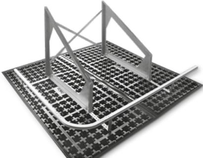
In Kombination mit der ZinCo Solarbasis® SB 200 und Solargrundrahmen SGR oder der ZinCo Geländerbasis GB/GB-Eck zu montierendes Schienensystem mit horizontal beweglichem Anschlagpunkt, dem sogenannten Läufer; geprüft als durch Auflast gehaltene Anschlagvorrichtung gegen Absturz gemäß DIN EN 795:2012 Typen D und E.
