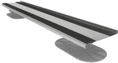
Bei der Plattenverlegung in Randbereichen, die nicht rechtwinkelig zur Verlegrichtung der Platten verlaufen, wird das Elefeet® Gehrungs- und Randauflager genutzt. Das ca. 170 mm breite Profil wird parallel zum Randbereich auf den Elefeet® gelegt und lagert selbst kleine Belagszuschnitte auf. Die durchgehende, 15 mm hohe Aufkantung fasst den Plattenbelag ein. Die aufgebrachte Gummierung sorgt für eine rutschsichere Auflage.
