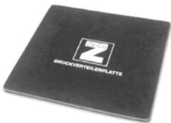
Zum Schutz der Abdichtungsebene vor hohen Punktlasten und damit verbundenen Folgeschäden, wird die Druck-Verteilerscheibe direkt unterhalb des Elastoring verlegt. Die ca. 200 mm x 200 mm große Scheibe aus Gummi erhöht den Aufbau um ca. 4 mm.
