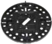
Auflageteller aus RC-Polypropylen-Kunststoff für die Plattenverlegung auf ZinCo Elefeet Auflage-Schiene; Höhe Teller ca. 6 mm, Durchmesser ca. 120 mm; mit 3 mm Fugenteiler; Pack à 50 Stück; vorgelocht zum Aufschrauben auf die Auflage-Schiene; incl. 52 St. Schrauben SIT 20 und Bit
