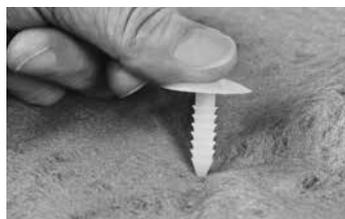
Aus Polyethylen; zur punktuellen Befestigung von Filtervliesen auf allen Dränelementen aus EPS-Hartschaum (Floraset®). Bedarf: ca. 1 Vliesknopf/m<sup>2</sup>. Kopfdurchmesser: ca. 30 mm; Stiftdurchmesser: ca. 8 mm; Stiftlänge: ca. 34 mm.
