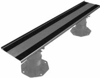
Bei der Plattenverlegung in Randbereichen, die nicht rechtwinkelig zur Verlegrichtung der Platten verlaufen, wird das Elefeet®-Gehrungs- und Randaufleger genutzt. Das 170 mm breite Profil wird parallel zum Randbereich auf den Elefeet® gelegt und lagert selbst kleine Belagszuschnitte auf. Die durchgehende, 15 mm hohe Aufkantung fasst den Plattenbelag ein. Die aufgebraute Gummierung sorgt für eine rutschsichere Auflage.
