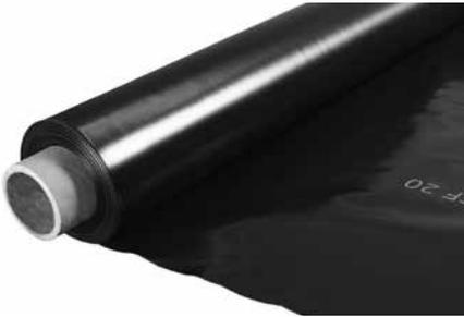
Chemisch neutrale Hochdruck-Polyethylenfolie zum Einsatz als Trenn- und Gleitfolie unter Dachbegrünungen oder Geh- und Fahrbelägen; bitumen- und polystyrolverträglich; beständig gegenüber den meisten Chemikalien; UV-stabilisiert; glatte Oberfläche; dampfsperrend ( $s_d \geq 100$  m); Farbe: schwarz; Dicke: ca. 0,20 mm; Flächenmasse: ca. 190 g/m<sup>2</sup>.
