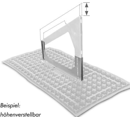
Unterteil aus Aluminium zur stufenlosen Höhenverstellung des Solar-Grundrahmens von bis zu 21 cm. Der Neigungswinkel von 5° bis 45° lässt sich um bis zu ± 2° verändern. Diese Eigenschaften garantieren eine optimale Anpassung an wechselndes Dachgefälle sowie eine bestmögliche Ausrichtung der Module.
