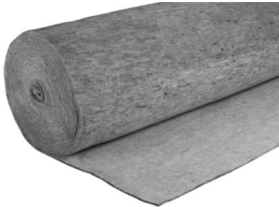
Unverrottbare Synthefasermatte aus einem Polyester/Polypropylen-Gemisch; verwendbar als Schutzlage über Wurzelschutzfolien oder Dachdichtungen; besonders hohe Wasserspeicherung; bitumenverträglich; biologisch und chemisch neutral; reißfest; Festigkeitsklasse 4; hergestellt aus Recyclingfasern. Mit geprüfter Schutzwirkung gemäß EN ISO 13428. Wasserspeicherkapazität: ca. 7 l/m<sup>2</sup>; Dicke: ca. 7 mm; Flächenmasse: ca. 650 g/m<sup>2</sup>.
