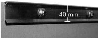
Schlankes Anpressprofil z. B. zur Fixierung von Wurzelschutzbahnen bzw. -folien oder von Teichbahnen an Betontrögen, Winkelsteinen etc.; aus Aluminium-natur; stranggepresst; vorgelocht im Abstand von ca. 200 mm; Profil-Höhe: ca. 40 mm.
