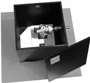
Bewässerungsautomat aus schlagzähem **Polyethylen**; mit robuster, **mechanischer Schwimmersteuerung**; Deckel verschließbar. Gemäß DIN 1988 ist ein Geräteventil bauseits erforderlich. Bei Bedarf ist der B 32 auch mit Folien-Manschette lieferbar (wie Abbildung Kontrollschacht KS 30-Edelstahl auf Seite 28). Farbe: schwarz; Anschluss: 1/2"- Rohr- oder Schlauchleitung. Gewicht: ca. 7 kg; Schacht-Außenmaß: ca. 300 mm × 300 mm; Öffnungsmaß: ca. 270 mm × 270 mm.
