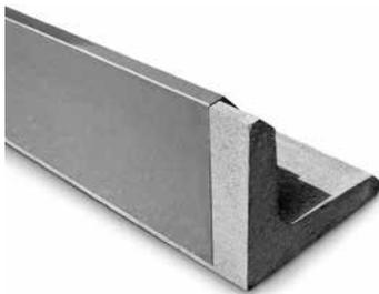
Blende für Betonwinkelstein aus gekantetem, foliertem Edelstahlblech; Höhe 240 mm; damit bei beiden Verlegearten (250- oder 300 mm-Schenkel nach oben) einsetzbar; Profillänge 2 m; mit integriertem Stoßverbinder. Vorgefertigte Innen- und Außenecken auf Anfrage; Gewicht: ca. 5,0 kg.
