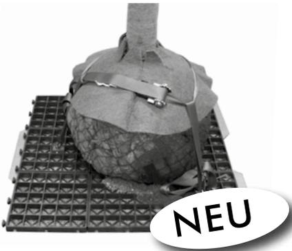
Auflast gehaltenes Baumverankerungssystem; speziell für den Einsatz in Dachbegrünungen entwickelte Wurzelballenverankerung bis ca. 1,0 m Ballendurchmesser. Bestehend aus 3 Ankerplatten ca. 40 × 40 cm; Aluminium/Edelstahl mit Edelstahlschäkel; Rasterelement (RC HDPE) ca. 1,00 × 1,00 m; Höhe ca. 30 mm; inkl. verstellbaren Gurten, die mittels Ratsche befestigt werden; Ratsche abnehmbar; inkl. Kokos-Schutzmatte; Durchmesser 80 cm; Gewicht ca. 17,5 kg.
