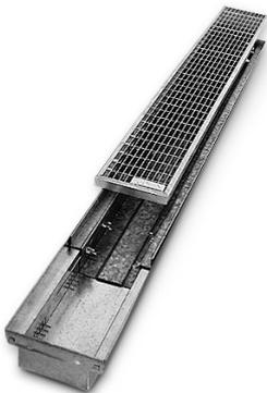
Wie auf Seite 30, jedoch längenverstellbar durch teleskopartig verschiebbaren Rinnenkörper. Der Gitterrost ist entsprechend abzulängen und an der Schnittstelle gegen Korrosion zu schützen. Erhältlich in den Maßen 0,60 m–1,00 m und 1,15 m–2,00 m; Höhe 50 mm; Gewicht: 5,4 kg bzw. 10,0 kg.
