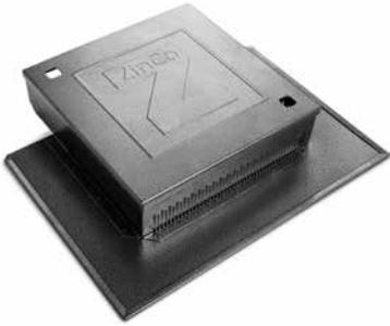
Kontrollschacht aus verzinktem und beschichtetem Stahlblech; mit dreiseitigem Flansch; speziell für in der Attika liegende Abläufe oder Wasserspeier; auch an Aufkantungungen mit Dämmstoffkeil einsetzbar, da Ecken perforiert und ohne Werkzeuge schräg abknickbar; kombinierbar mit den Aufstockelement KSA 8/30 und KSA 20/30, siehe oben. Schacht-Außenmaß: ca. 300 mm × 300mm; Öffnungsmaß: ca. 240 mm × 240 mm; Flansch an drei Seiten ca. 85 mm.
