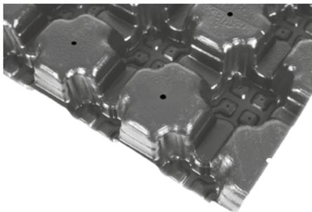
Leistungsfähiges und extrem transportfreundliches Spacer-Element aus tiefgezogenem RC-Polyolefin, Höhe ca. 60 mm; Flächenmasse ca. 2,2 kg/m<sup>2</sup>; mit unterseitigem Mehrrichtungkanalsystem und Verbindungsnoppen an Stirn- und Längsseiten, max. Einstauvolumen ca. 55 l/m<sup>2</sup>; Druckfestigkeit nach DIN EN ISO 25619-2: 40 kPa; zum Einsatz bei Retentions-Gründächern auf Dachflächen ohne Gefälle.
