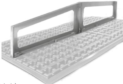
Schraubenset zum Herstellen einer Ost-West ausgerichteten Solaraufständerung, um die SB 200-4 und zwei SGR zu montieren. Pro Aufständerung werden zwei SGR (siehe Seite 44), Art.-Nr. 9700xx und eine SB 200-4 Art.-Nr. 3465 benötigt. Die Montage kann mit einem Hochpunkt zwischen den beiden Modulreihen erfolgen („Sattel“) oder mit einem Tiefpunkt („Schmetterling“). Material: Edelstahl.
