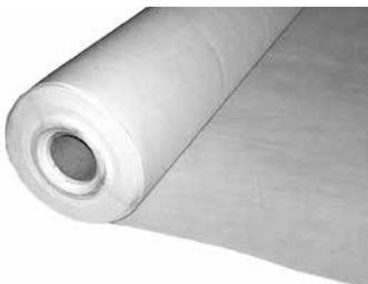
Hitzebeständiges Vlies aus verfestigtem Polyester zum Einsatz auf Elastodrain® EL 202 für den Handeinbau von Asphaltbelägen. Bitte Einbauanleitung beachten! Dicke ca.  $1,0\text{--}1,4 \text{ mm}$ , Flächenmasse ca.  $200 \text{ g}/\text{m}^2$ , Farbe weiß, Höchstzugkraft min.  $400 \text{ N}/5\text{cm}$ , Reißdehnung längs/quer ca.  $35/50 \%$ , Schmelzpunkt  $> 200 \text{ }^\circ\text{C}$ .
