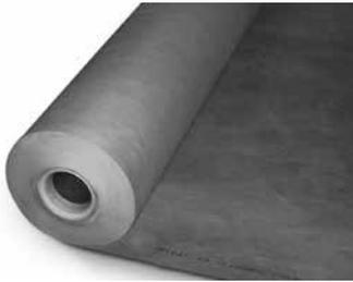
Thermisch verfestigtes Filtervlies aus Polypropylen; **mechanisch hoch belastbar**, daher einsetzbar auf Dränschüttungen; Wasserdurchlässigkeit  $H_{50}$  nach EN ISO 11058: ca.  $40 \text{ l}/(\text{m}^2 \times \text{s})$ ; Öffnungsweite ( $O_{90}$ ) nach EN ISO 12956: ca.  $85 \mu\text{m}$ , Geotextilrobustheitsklasse 3; Flächenmasse:  $\geq 175 \text{ g}/\text{m}^2$ .
