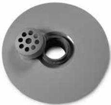
Anstaulement PE zur Bildung eines Wasseranstaus auf der Abdichtung von 0°-Dächern für eine Langzeitbewässerung, vor allem von Intensivbegrünungen; mit Flansch aus Polyethylen zum Einbinden in Abdichtungs- oder Wurzelschutzbahnen aus FPO (z. B. Wurzelschutzbahn WSB 100-PO) und mit abnehmbarem Aufsatzstück aus Kupfer; inkl. Dichtungsring; Aufsatzstück für Anstauhöhe: ca. 40 mm. Durchmesser Stutzen: ca. 90 mm; Gewicht: ca. 0,5 kg.
