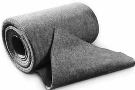
Für den Einsatz in Dachrand- und Anschlussbereichen konzipierter Schuttmatten-Streifen aus Polyesterfasern, insbesondere geeignet für die Kombination mit Fixodrain® XD 20. Als Montagehilfe rückseitig mit Haftkleber besprüht; bitumenbeständig, biologisch und chemisch neutral; Dicke: ca. 3 mm; Flächenmasse: ca. 320 g/m<sup>2</sup>.
