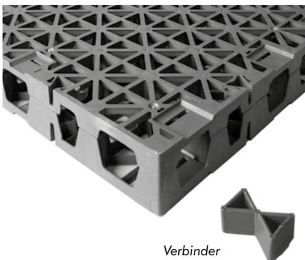
Leistungsfähiges, hochbelastbares und trotzdem leichtes Spacer-Element, im Spritzgussverfahren hergestellt aus Polypropylen, Farbe Grün, Höhe ca. 65 mm bzw. 100 mm; mit innen liegendem Hohlraumsystem; max. Einstauvolumen ca. 60 l/m<sup>2</sup> bzw. 95 l/m<sup>2</sup>; Druckfestigkeit nach DIN EN ISO 25619-2: 500 kPa, zum Einsatz bei Retentions-Gründächern auf Dachflächen ohne Gefälle; auf denen z.B. Geh- oder Fahrbeläge oder hohe Substratschüttungen realisiert werden sollen.
