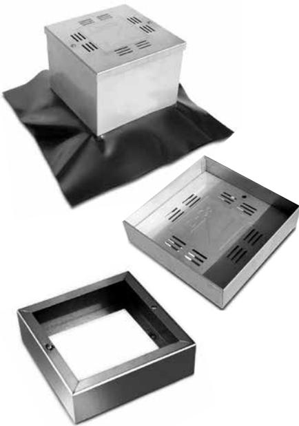
Hochwertiger Kontrollschacht aus **Edelstahl (V2A)** mit ringsumlaufender Schlitzlochung zur Aufnahme von Dränwasser; verschließbarer, trittstabiler Deckel mit Wassereinlassöffnungen und mit in der Höhe verschiebbarer Folien-Manschette zum lückenlosen Anschluss des Systemfiltervlieses. Farbe: Edelstahl natur; Gewicht: ca. 4,0 kg; Schacht-Außenmaß: ca. 300mm × 300mm; Öffnungsmaß: ca. 240 mm × 240 mm.
