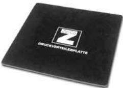
Zum Schutz der Abdichtungsebene vor hohen Punktlasten und damit verbundenen Folgeschäden, wird die Druck-Verteilerscheibe direkt unterhalb des Elastoring verlegt. Die 200 mm × 200 mm große Scheibe aus Gummi erhöht den Aufbau um ca. 4 mm.
