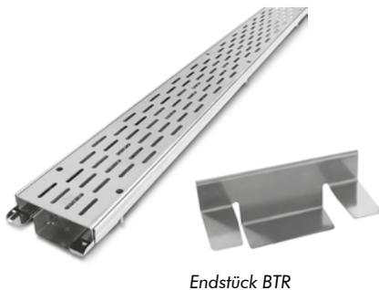
Höhenverstellbare Rinne aus hochwertigem Edelstahl; Abdeckung mit Langlochschlitzung, Rinnenkörper unten/seitlich geschlitzt, einschließlich Stoßverbinder. Rinnenbreite: ca. 107 mm; Breite der Abdeckung: 100 mm; Höhenverstellbereich: ca. 40 bis 55 mm.
