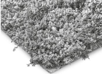
Über eine Vegetationsperiode im Freien vorkultivierte Pflanzenmatten für die schnelle Flächendeckung; speziell geeignet bei Schräg- und Tonnendächern oder windexponierten Dachflächen; mit fest verwurzelten Pflanzen (4–8 bewährte Sedum-Sorten sowie für extensive Dachbegrünung geeignete Kräuter und Gräser) auf einer verrottungsfähigen Trägereinlage; geringfügiger Schrumpf und Fremdbewuchs ist möglich.
