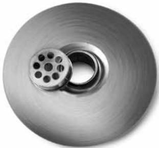
**Anstaeuelement Kupfer:** Zur Bildung eines Wasseranstaues auf der Dachabdichtung für eine Langzeitbewässerung, vor allem von Intensivbegrünungen; aus Kupfer mit Klebeflansch und abnehmbarem Aufsatzstück; inkl. Dichtungsring; zum Einkleben in bituminöse Abdichtungen; Aufsatzstück für Anstauhöhe: ca. 40 mm. Durchmesser Stutzen: ca. 90 mm; Gewicht: ca. 1,0 kg.
