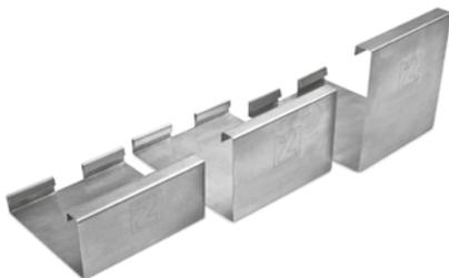
Die ideale Art, die DP-Profile zu fixieren, ohne in die Dachabdichtung einzugreifen. Der DP-Fix-Halter aus Aluminium wird mit einer 750 mm × 500 mm großen, vorgeschlitzten Fixiermatte geliefert. Als Stoßverbinder sorgt er für ein homogenes Erscheinungsbild. Es kann bis zu einer Dachneigung von 5° als Abschlussprofil, zur Einfassung von Begrünungen, als Kiesfangleiste oder als Übergangsprofil (Kies/Begrünung/Plattenbelag) eingesetzt werden. Auf Anfrage auch in Edelstahl erhältlich.
