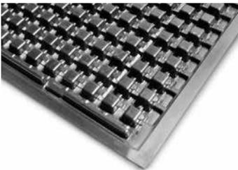
Drän- und Wasserspeicherelement aus tiefgezogenem Recycling-Polystyrol, insbesondere für den Einsatz unter Fahrbelägen oder begrünten Stellplätzen; auch auf Umkehrdächern einsetzbar; extrem stabil; maximale Druckbelastung (ohne Verfüllung): ca. 500 kN/m<sup>2</sup>; Spezielle Verbindungsnoppen an den Plattenrändern erlauben die Verlegung der SD 30-Elemente im Verband; ein Mehrbedarf von ca. 3 % ist daher einzukalkulieren. Flächenmasse: ca. 3 kg/m<sup>2</sup>; Höhe: ca. 32 mm.
