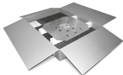
Durch Auflast gehaltene, dachdurchdringungsfreie Anschlagereinrichtung gegen Absturz gemäß DIN EN 795:2012 Typ E, bestehend aus zu einer Scheibe zusammengesteckten und mit Substrat oder Kies überschütteten Risterelementen und einem im Innenbereich der Scheibe platzierten Anschlagpunkt mit Ringöse.
