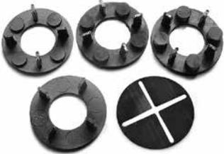
Ringförmige Plattenlager aus Synthekautschuk; Durchmesser 120 mm; in den Fixhöhen 5, 10, 15 und 20 mm. Mit integrierten Fugenteilern in 5 mm Stärke. Elastoring ist auf Dachflächen ohne Pfützenbildung einzusetzen. Geringe Unebenheiten der Dachoberfläche sind durch unterschiedliche Ringhöhen und die 1 mm dicken Distanzscheiben auszugleichen.
