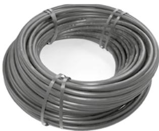
Druckkompensierender Tropfschlauch für die Bewässerung von Dachbegrünungen in Verbindung mit dem Aquafleece® AF 300, Durchmesser ca. 16 mm, mit im Schlauch angeordneten Tropfern, Tropferabstand ca. 500 mm; Tropferleistung ca. 1,6 l/h; Druckkompensation zwischen 0,4 und 2,5 bar.
