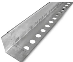
**Traufprofil TRP 140,** biegesteifes Winkelprofil aus Edelstahl insbesondere zum Einsatz als Traufabschluss bei begrünenden Schrägdächern in Verbindung mit Traufschubhaltern; mit Schlitzlochung für Wasserdurchlass und angeschweißtem Stoßverbinder. Höhe senkrechter Schenkel: 140 mm.
