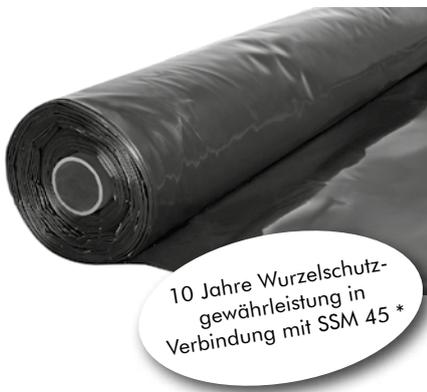
Seit Jahrzehnten bewährte, reißfeste und widerstandsfähige Hochdruck-Polyethylenfolie für den Einsatz als lose verlegter Wurzelschutz vor allem unter extensiven Dachbegrünungen und zur Auskleidung von Trögen. Wurzelfest; bitumen- und polystyrolbeständig; weichmacherfrei; huminsäure- und ölbeständig; UV-stabilisiert; WDD-äquivalente Luftschichtdicke nach DIN 52615: sd – 200 m; Farbe: schwarz. Dicke: ca. 0,34 mm; Flächenmasse: ca. 320 g/m<sup>2</sup>.
