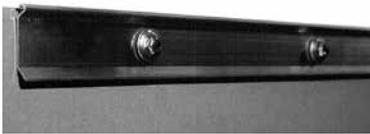
Schlankes Anpressprofil z. B. zur Fixierung von Wurzelschutzbahnen bzw. -folien oder von Teichbahnen an Betonrögen, Winkelsteinen etc.; aus Aluminium-natur; strang-gepresst; vorgelocht im Abstand von ca. 200 mm; Profilhöhe: ca. 40 mm.
