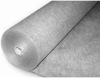
Filtervlies aus vorkomprimiertem und thermisch verfestigtem Polypropylen; verrottungsbeständig; einsetzbar als Filterschicht auf den ZinCo Dränelementen bei **normaler mechanischer Beanspruchung**; Wasserdurchlässigkeit  $H_{50}$  nach EN ISO 11058: ca.  $70 \text{ l}/(\text{m}^2 \times \text{s})$ ; Öffnungsweite ( $O_{90}$ ) nach EN ISO 12956: ca.  $95 \mu\text{m}$ ; Geotextilrobustheitsklasse 2; Flächenmasse: ca.  $100 \text{ g}/\text{m}^2$ .
