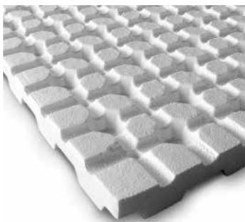
**Dränplatte zum Einsatz unter Extensivbegrünungen auf Flachdächern mit und ohne Gefälle;** aus EPS-Hartschaum; FCKW-frei; ohne HBCD; mit Wasserspeichermulden; Öffnungen zur Belüftung und Diffusion sowie unterseitigem, durchgehendem Kanalsystem; Dränageleistung geprüft nach DIN EN ISO 12958; Rohdichte: ca. 20 kg/m<sup>3</sup>; Flächenmasse: ca. 0,6 kg/m<sup>2</sup>; Höhe: ca. 50 mm.
