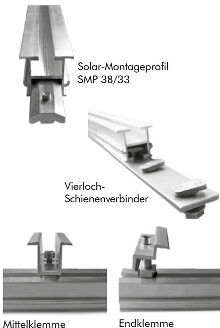
**Solar-Montageprofil SMP 38/33:** aus stranggepresstem Aluminium-Natur AlMgSi 0.5; pressblank; mit ober- und unterseitigem Profilkanal; B x H = 38 x 33 mm, Gewicht ca. 0,75 kg/m; einschließlich Stoßverbinder mit Schraubmittel.
