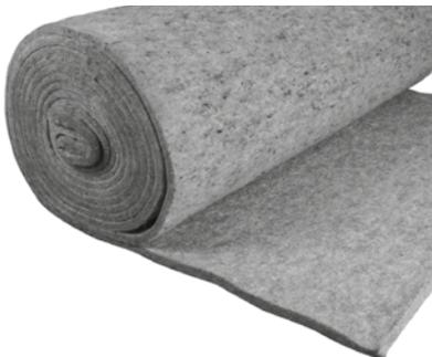
Unverrottbare, thermofixierte Nadelvliesmatte aus Mischfasern; verwendbar als Wasserspeichermatte unter Dachbegrünungen, speziell für geneigte Dächer; bitumenverträglich; biologisch und chemisch neutral; reißfest; hergestellt aus Recycling-Synthefasern. **Wasserspeicherkapazität: ca. 12 l/m<sup>2</sup>**; Dicke: ca. 17 mm; Flächenmasse: ca. 1500 g/m<sup>2</sup>.
