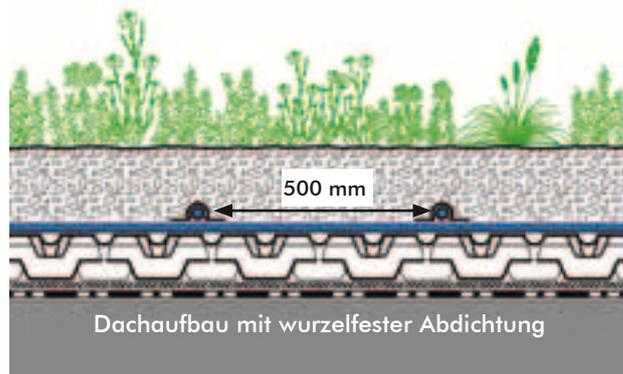
Dachaufbau mit wurzelfester Abdichtung
