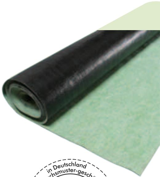
Das neue, gebrauchsmustergeschützte Aquafleece AF 300 ist das Kernstück der neuen Systemaufbauten „Klima-Gründach“ und „Bewässerte Extensivbegrünung“. Durch die Kombination eines hoch-kapillaren Vlieses mit einem Bändchengewebe kann das Aquafleece das Wasser im Bewässerungsfall verteilen, während es bei Niederschlägen das überschüssige Wasser flächig nach unten passieren lässt. So ist eine gleichmäßige Bewässerung möglich, eine Vernässung des Substrates aber wirkungsvoll unterbunden.
