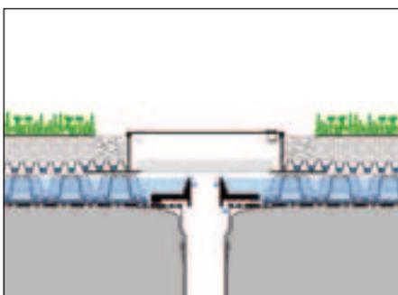
Bei extremen Niederschlagsereignissen staut sich das Wasser im Retentionsvolumen bis zur Oberkante des Staurohrs an.
