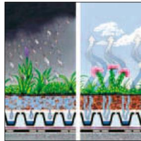
Gründächer halten, je nach Bauart, 50–90% der Niederschläge zurück und entlasten dadurch die Kanalisationssysteme. Ein Großteil dieses Wassers verdunstet, der Rest fließt zeitverzögert ab. Rohrleitungen, Kanäle, Überlaufbecken etc. können so kleiner dimensioniert, Entwässerungsgebühren evtl. gesenkt werden.
