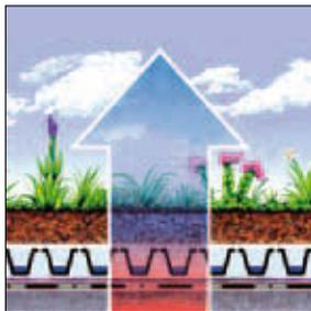
Dachbegrünungen verbessern den Dämmwert des Daches. Wärmedämmende Begrünungssysteme mit behördlich anerkannten Wärmedämmwerten lassen sich zur Wärmedämmung des Gebäudes hinzurechnen.
