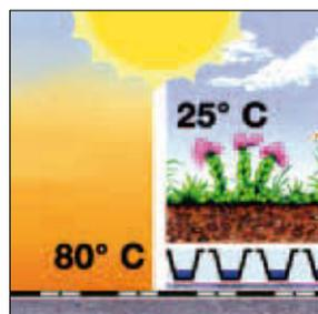
Unter einer Dachbegrünung liegt die Abdichtung wirksam geschützt vor UV-Strahlung, Hagelschlag, Hitze und Kälte. Temperaturbedingte Spannungen werden abgebaut und die Lebensdauer der Dachabdichtung somit wesentlich verlängert.
