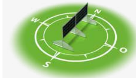
Senkrechte Anordnung bifacialer Module „Vertikal“
