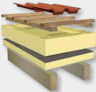
Aufsparrendämmung LINITHERM PAL N+F und LINITHERM PAL SIL T mit sichtbaren Sparren und putz-, streich- und tapezierfähigem Zwischen- sparrenbereich
