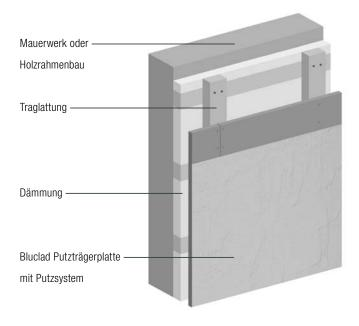
Die vorgehängte hinterlüftete Fassade VHF ist aus bauphysikalischen Gesichtspunkten die optimale Außenwandkonstruktion. Im Hinblick auf Wirtschaftlichkeit, Ökologie und Langlebigkeit gewinnt dieses überlegene System im Neubau und bei der Sanierung zunehmend an Bedeutung. Die VHF, auch Energieeinsparfassade® genannt, ist auf Holz-Unterkonstruktion bis zur Holzhausgrenze einsetzbar.
