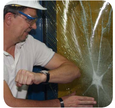
Dipl.-Ing. Volker Sigmar bei der Demonstration im Anschluss an einen Pendelschlagversuch. Umfassende Prüferfahrungen über den Brandschutz hinaus helfen dem Planer bei der anforderungsspezifischen Auswahl von Brandschutzgläsern mit Zusatzanforderungen.
