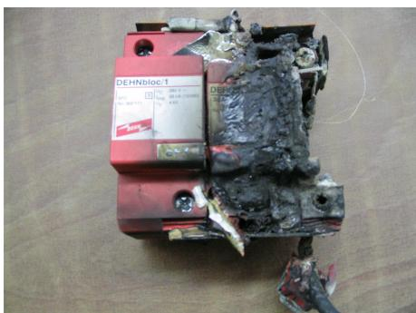
Jede Solaranlage sollte im Schutzbereich eines Blitzschutzsystems (BBS) liegen. Auch das Blitzschutzsystem wird von einigen Errichtern aus Kostengründen nicht angeboten und das Montagesystem nur in den Potenzialausgleich eingebunden. Das Risiko ist erheblich. Durch das Angebot und die Montage eines Blitz- und Überspannungsschutzes können viele Schäden vermieden und dadurch Kosten eingespart werden.
