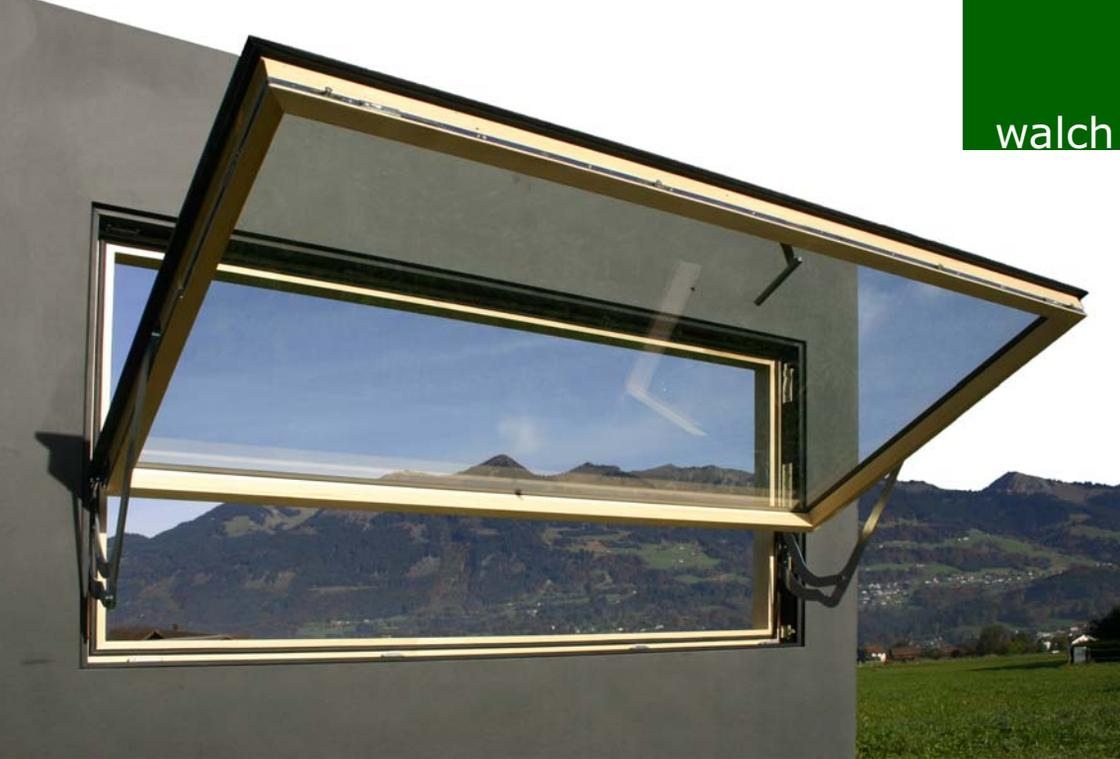
Das walchfenster04 ist ein neu entwickeltes, direkt verklebtes Holz-Glas-Fenstersystem für Fenster und Fassaden in Ganzglasausführung. Der Holzrahmen wird außen vollflächig von der Stufenglasscheibe abgedeckt und ist somit optimal vor Witterungs- und Umwelteinflüssen geschützt.
